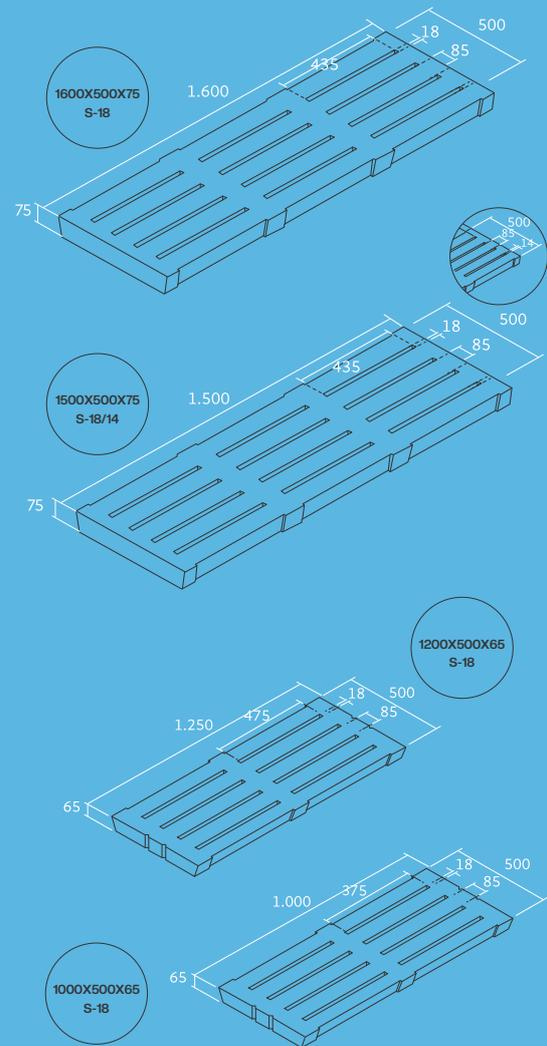
Las **Rejillas** son piezas modulares de rápido y fácil montaje. Estabilidad, fiabilidad y una excelente respuesta en el trabajo diario, garantizan un altísimo rendimiento en cualquier explotación ganadera. Están diseñadas para soportar los ambientes más abrasivos.
