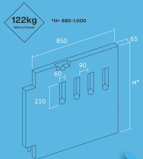
Las **Puertas de Hormigón** son resistentes, de fácil apertura y cierre sin esfuerzo, en el manejo a diario. Máxima durabilidad, fácil limpieza al ser lisas ambas caras y apertura dos posiciones.
