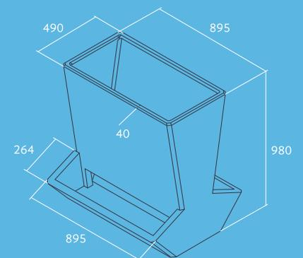
Las **Tolvas de Hormigón** están especialmente diseñadas para el engorde del ganado porcino, son versátiles, resistentes e idóneas por la selección del número de bocas adecuado a cada explotación. Con un alto índice de conversión, el animal no desperdicia el alimento.
